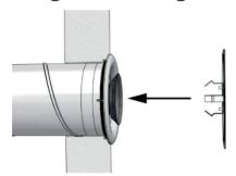
Arretieren Sie den Ventilkonus mit einer Flügelmutter. Die Stirnplatte wird durch das Eindrücken der Platte mit Clips in den Ventilkonus zum Ventil befestigt.
