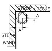
Für Rohrdurchmesser 125 mm Abstand "A" von der Wand und Decke min. 150 mm.
