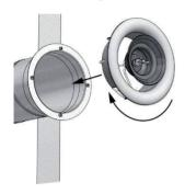
Drücken Sie den Ventilkörper in das Element ein und drehen Sie ihn dabei im Uhrzeigersinn.
