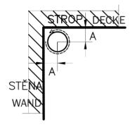
Für Rohrdurchmesser 125 mm Abstand "A" von der Wand und Decke min. 110 mm.
